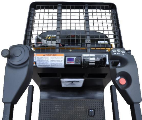
Big Joe: Left Hand Mini Steering Wheel Right Hand Fingertip Travel Control
